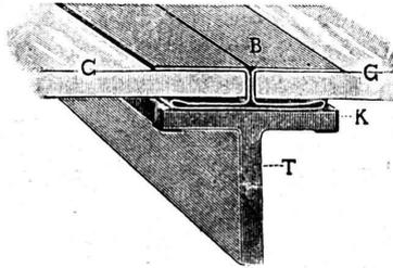
à moyeu de bandes de plomb. Est la plus solide, la plus commode, et la plus propre.
