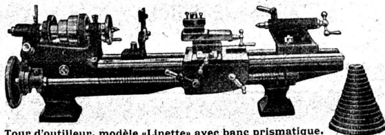
Tour d'outilleur, modèle «Linette» avec banc prismatique.
