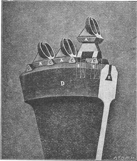
Fig. 40. — Mode de fixation des aubes.
