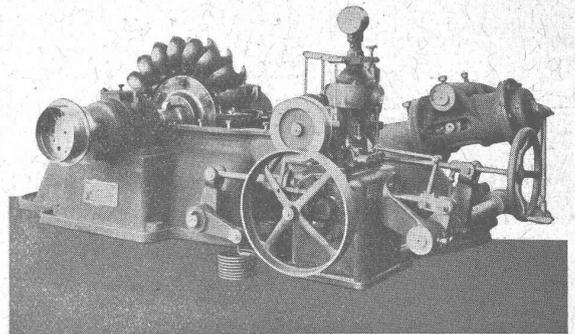
Turbine Pelton des ELEKTROWERKE REICHENBACH, à Meiringen. Chute 210 m. — Puissance 600 ch. Vitesse 750 t : min.
