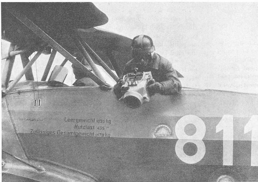
Fig. 1. — Levé au moyen d'un appareil incliné, tenu à la main.
