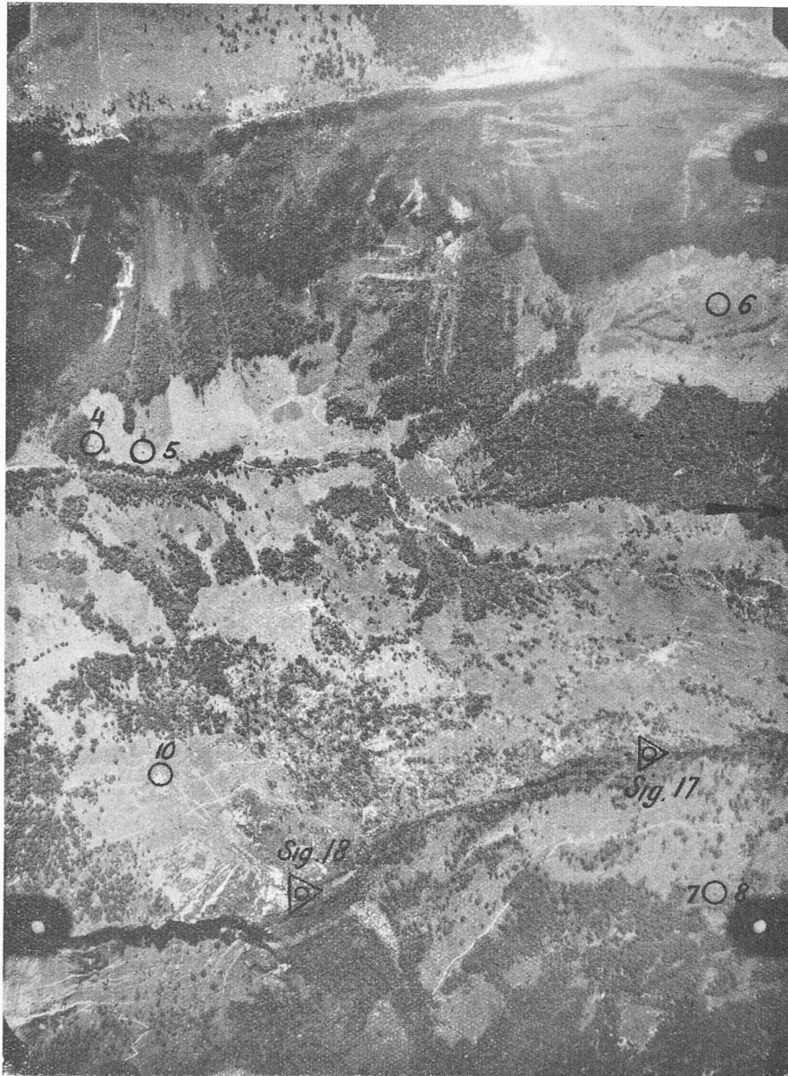
Fig. 3. — Levé stéréophotogrammétrique, par avion, du cadastre de Bilten-Niederurnen. Vue verticale convergente. Altitude de l'avion au-dessus de la mer, 4274 mètres.
