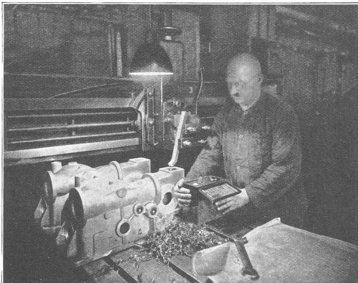
Fig. 7. — Mesure de l'éclairement sur l'établi d'une machine-outil.
