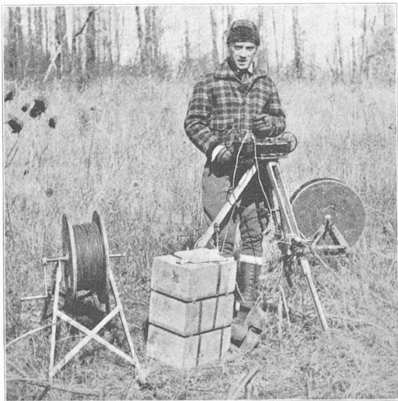
Fig. 7. — Exécution d'un sondage électrique. L'opérateur est à l'appareil de mesure. Devant lui trois batteries de piles sèches pesant chacune 12 kg. Le câble en réserve sur les deux bobines va permettre d'éloigner progressivement les pôles A et B.
