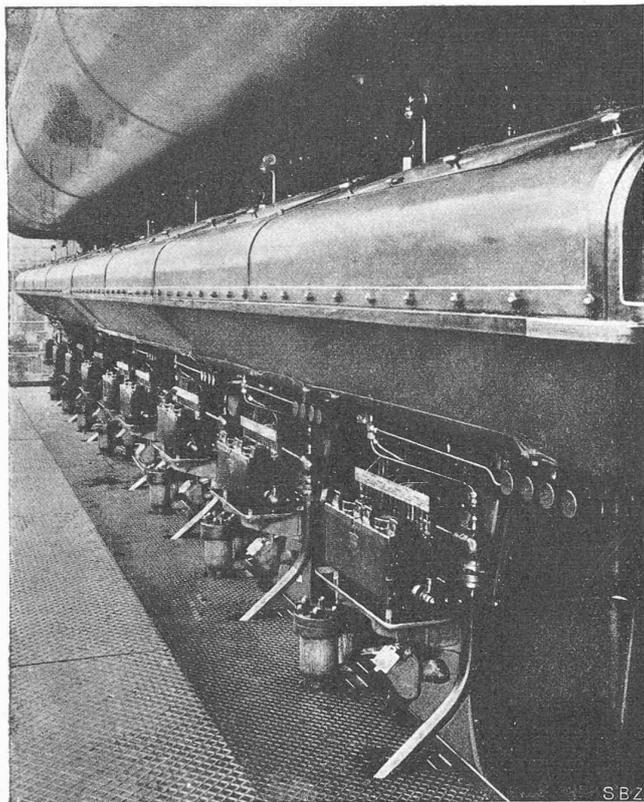
Fig. 6. — Plate-forme inférieure et carter de l'arbre à cames.
