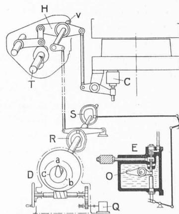
Fig. 9. — Schéma du dispositif de démarrage.
