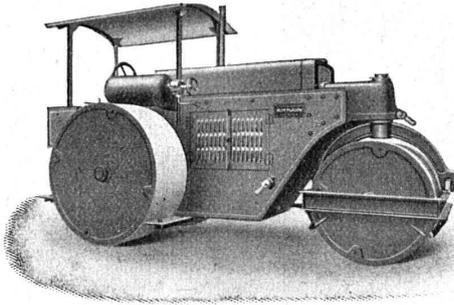
Rouleaux-compresseurs Diesel 3 à 12 tonnes.
