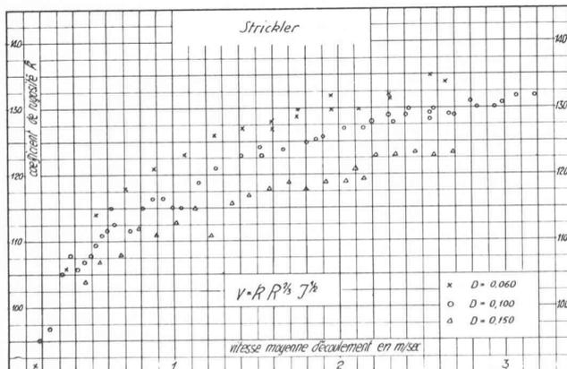
Fig. 3. — Application de la formule de Strickler. La valeur du coefficient empirique  $K$  loin d'être une constante de rugosité, varie avec la vitesse et le diamètre du tuyau. L'emploi de cette formule nécessiterait la détermination préalable dans chaque cas particulier de la valeur de  $K$ .
