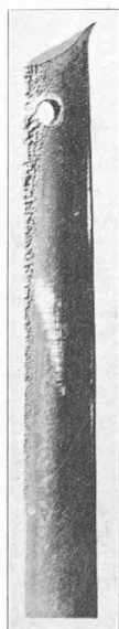
Fig. 2. — Ailette de turbine érodée par les gouttes d'eau en suspension dans la vapeur.
