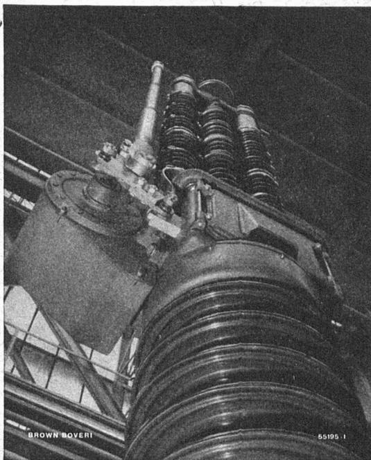
Pôle d'un disjoncteur pneumatique ultra-rapide de 220 000 V.
