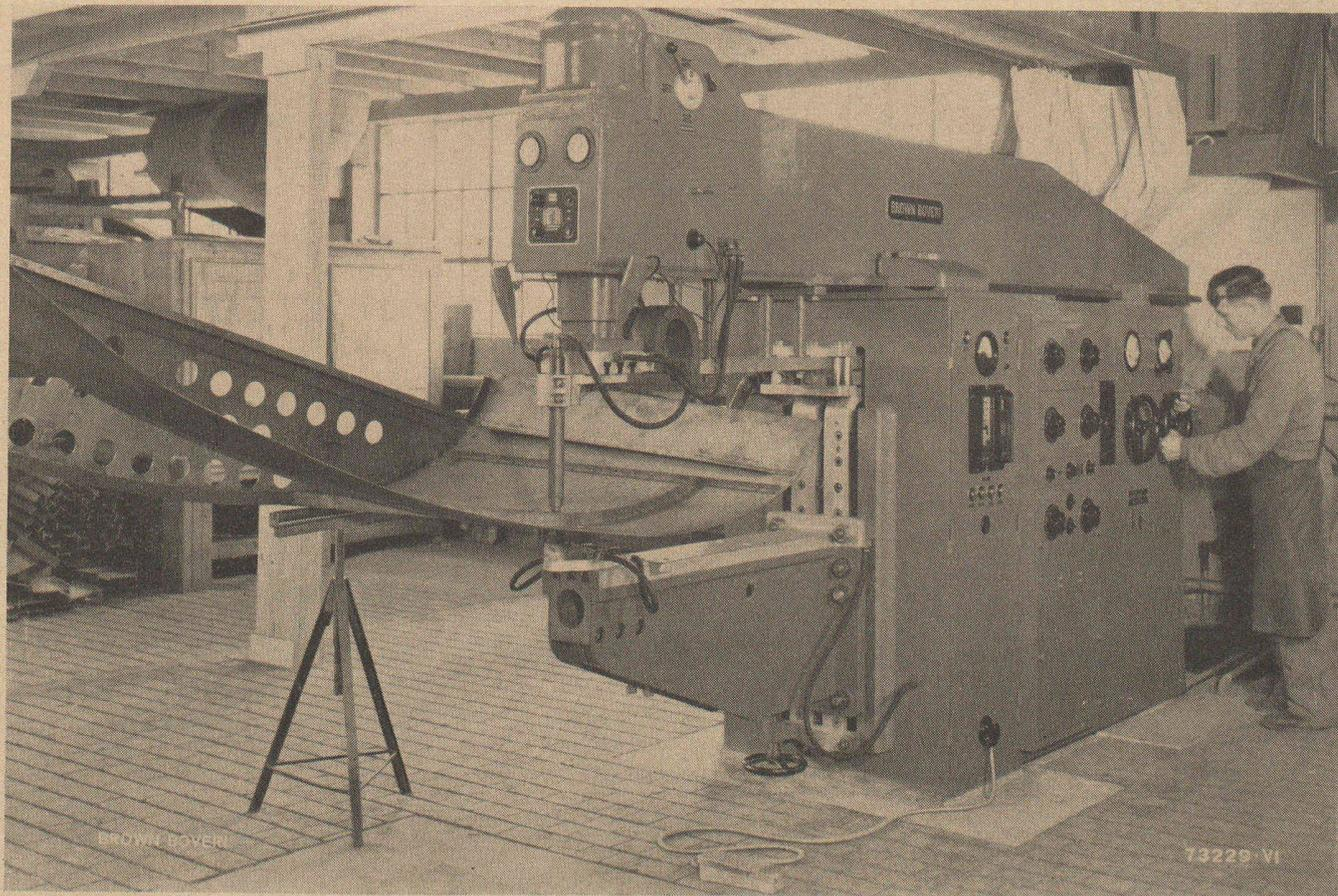
Machine à souder par points et à la molette Brown Boveri, la plus grande qui ait été construite jusqu'ici. Sa puissance maximum est de 1000 kVA, la longueur utile maximum des bras de 1500 mm et l'effort maximum de pression des électrodes de 3000 kg.
