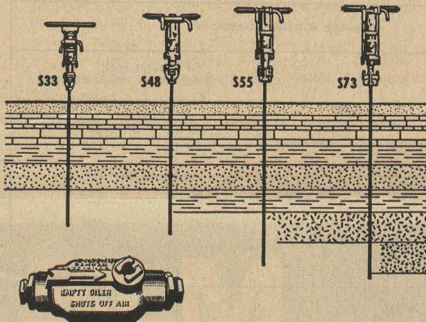
Vos perforateurs seront toujours suffisamment graissés en utilisant le graisseur automatique type LO 12. Etant dépourvu d'huile, il fermera automatiquement l'arrivée d'air à l'outil pneumatique.
