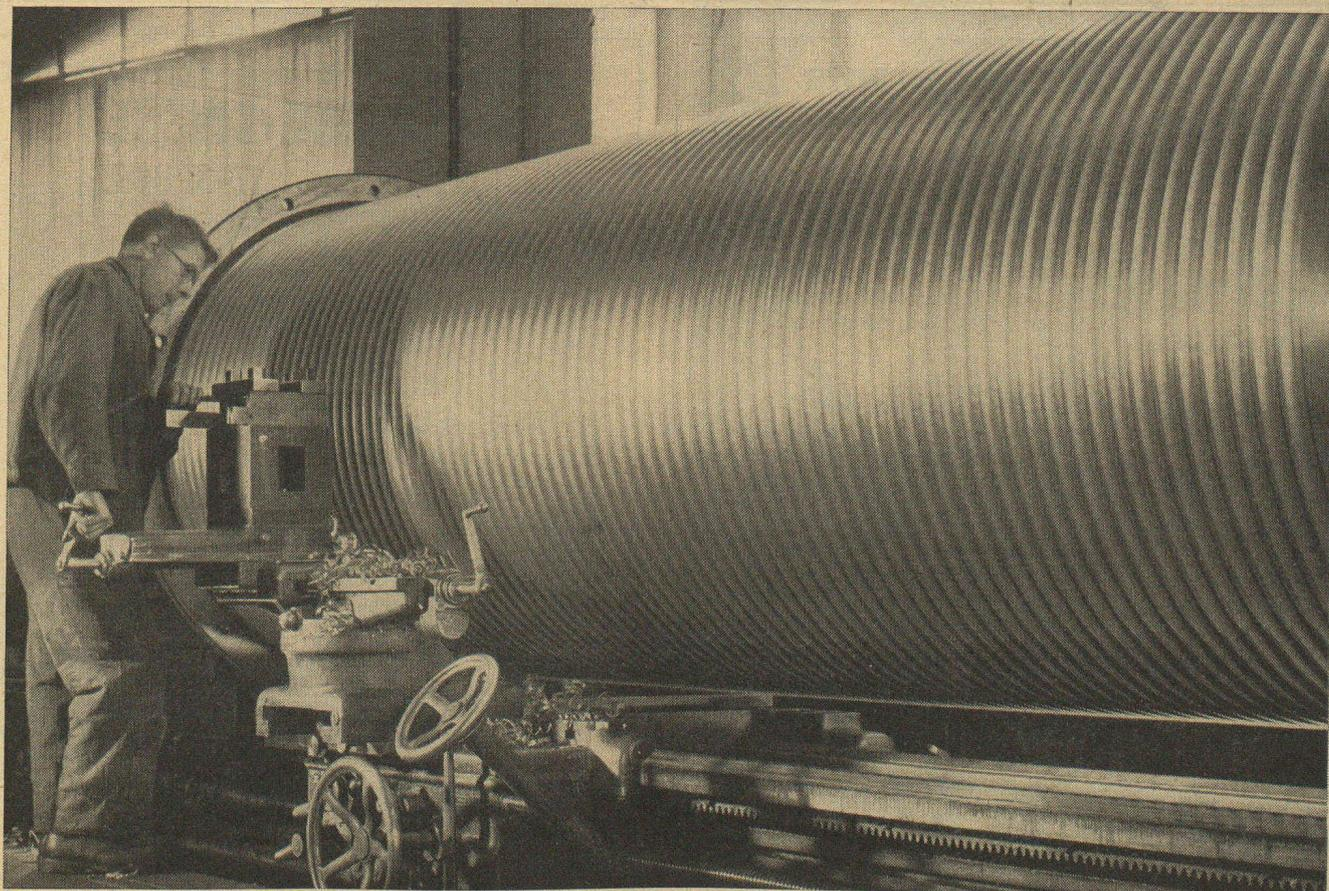
Tambour du treuil pour le funiculaire à matériel de l'Usine hydro-électrique souterraine des Clées
