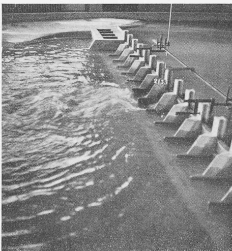
Fig. 29. — Ecoulement non conforme à la consigne de manœuvre des vannes.
