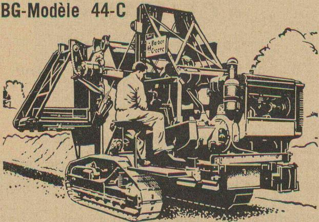
Pour les travaux les plus durs, monté sur chenilles, profondeur de travail jusqu'à 2,5 m, largeur de travail 60 cm, éjection à gauche et à droite à tapis roulant, réglage mécanique de la hauteur de travail du train des godets, indicateur d'angle réglable.
