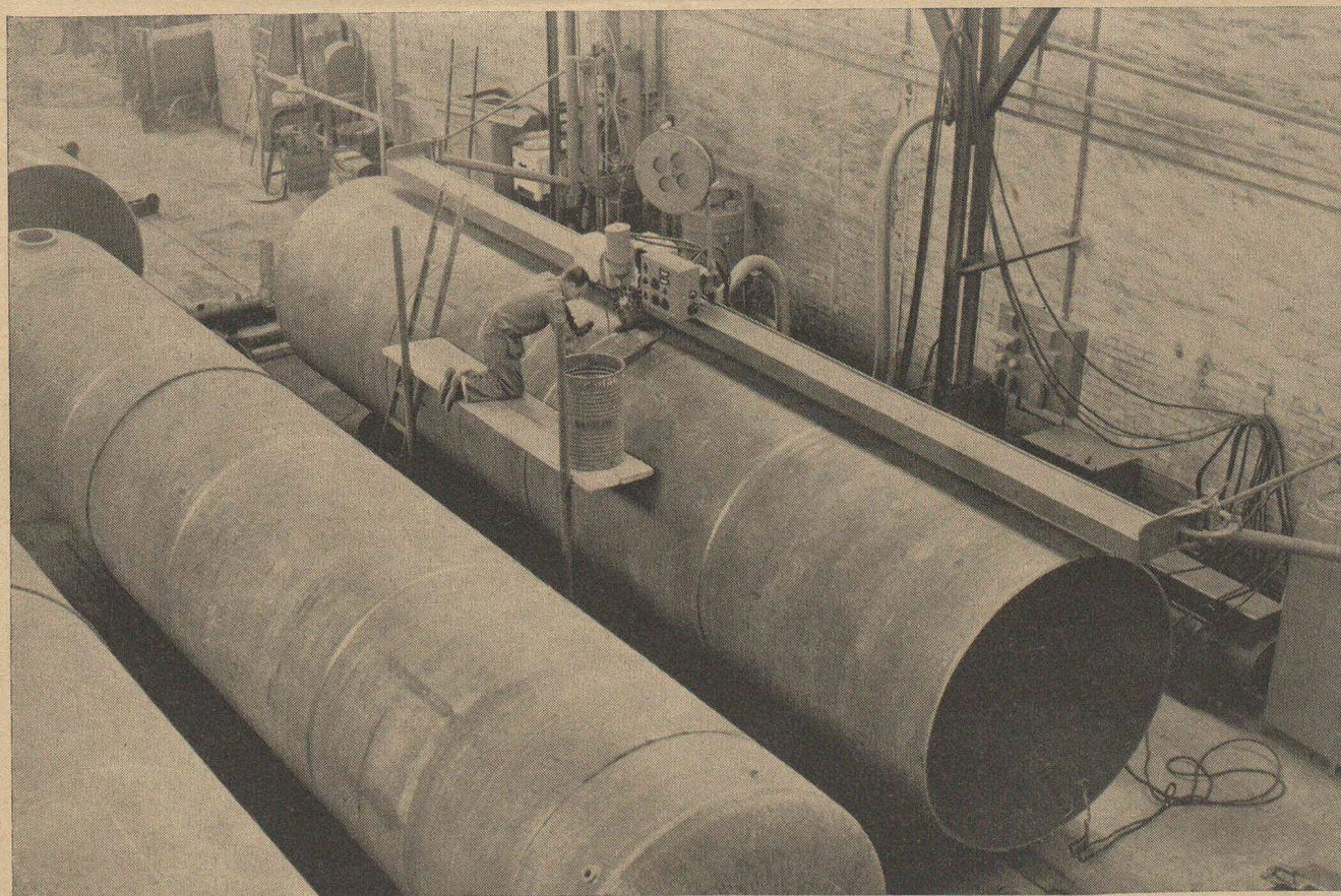
Les têtes automatiques Brown Boveri de soudage à l'arc permettent d'exécuter des conduites forcées
