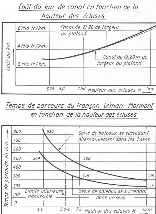
Fig. 3. — Détermination de la hauteur optimum des écluses.
