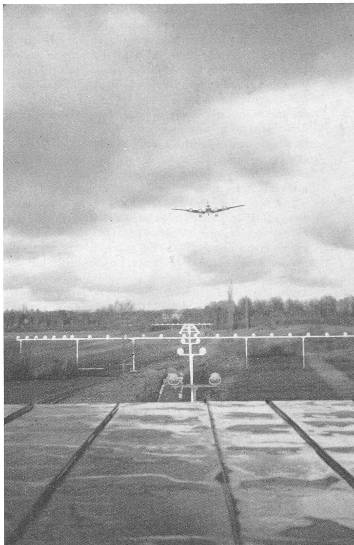
Une partie des lampes de la ligne de feux à haute intensité qui marque les 900 derniers mètres de l'approche avant la piste.
