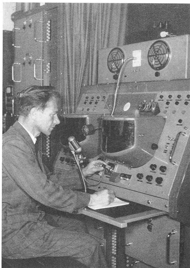
Le pupitre des écrans du radar d'approche. A droite, écran d'une portée de 20 km, à gauche, de 5 km.
