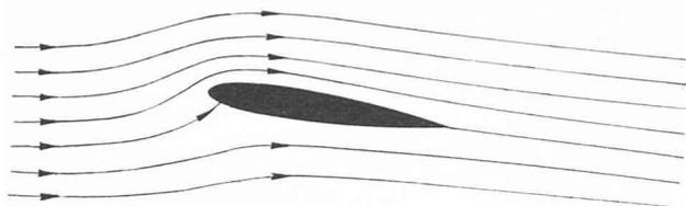
Fig. 4. — Ecoulement subsonique autour d'un profil d'aile.
