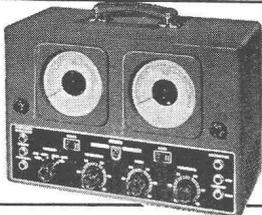
**Emetteur de contrôle pour récepteurs de télévision GM 2889**
