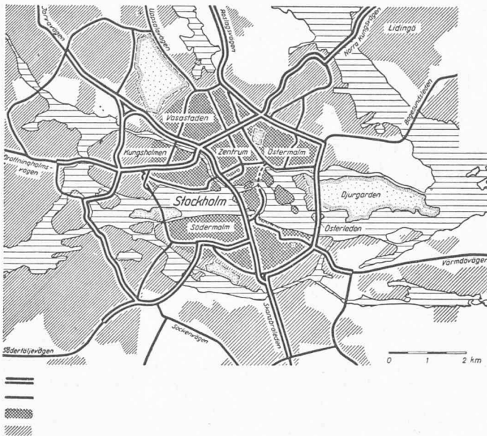
Fig. 1. — Réseau des routes express prévu à Stockholm.
