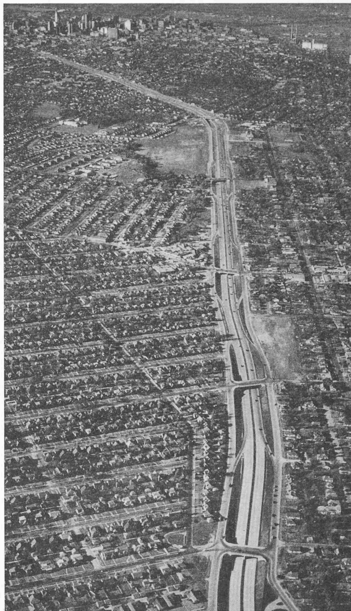
Fig. 13. — Route express à Dallas (Texas). Au fond, le noyau central de la ville. Route surbaissée, avec rampes d'accès latérales. Bonne liaison avec les dessertes latérales parallèles et avec le réseau urbain. Grosse emprise de terrain.
