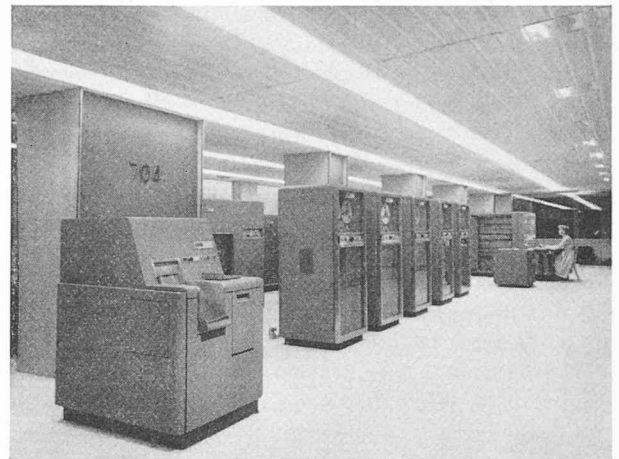
Fig. 2. — L'ordinateur IBM 704. Il comporte une mémoire centrale à tores magnétiques, des mémoires auxiliaires à tambours magnétiques et à bandes magnétiques.
