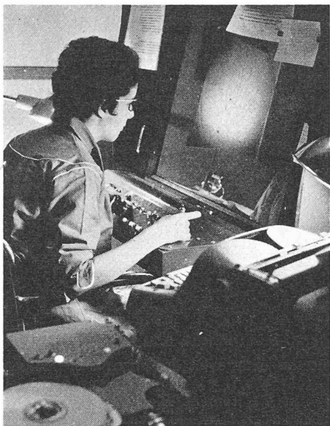
Fig. 9. — Opératrice procédant à l'enregistrement sur bande perforée de traces de particules, à l'aide d'un projecteur digitalisant.
