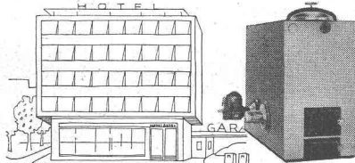
Chaudière de chauffage central 800: Pour tous combustibles, adaptable selon désir. 45 types pour 120 000 à 1 400 000 kcal/h.
