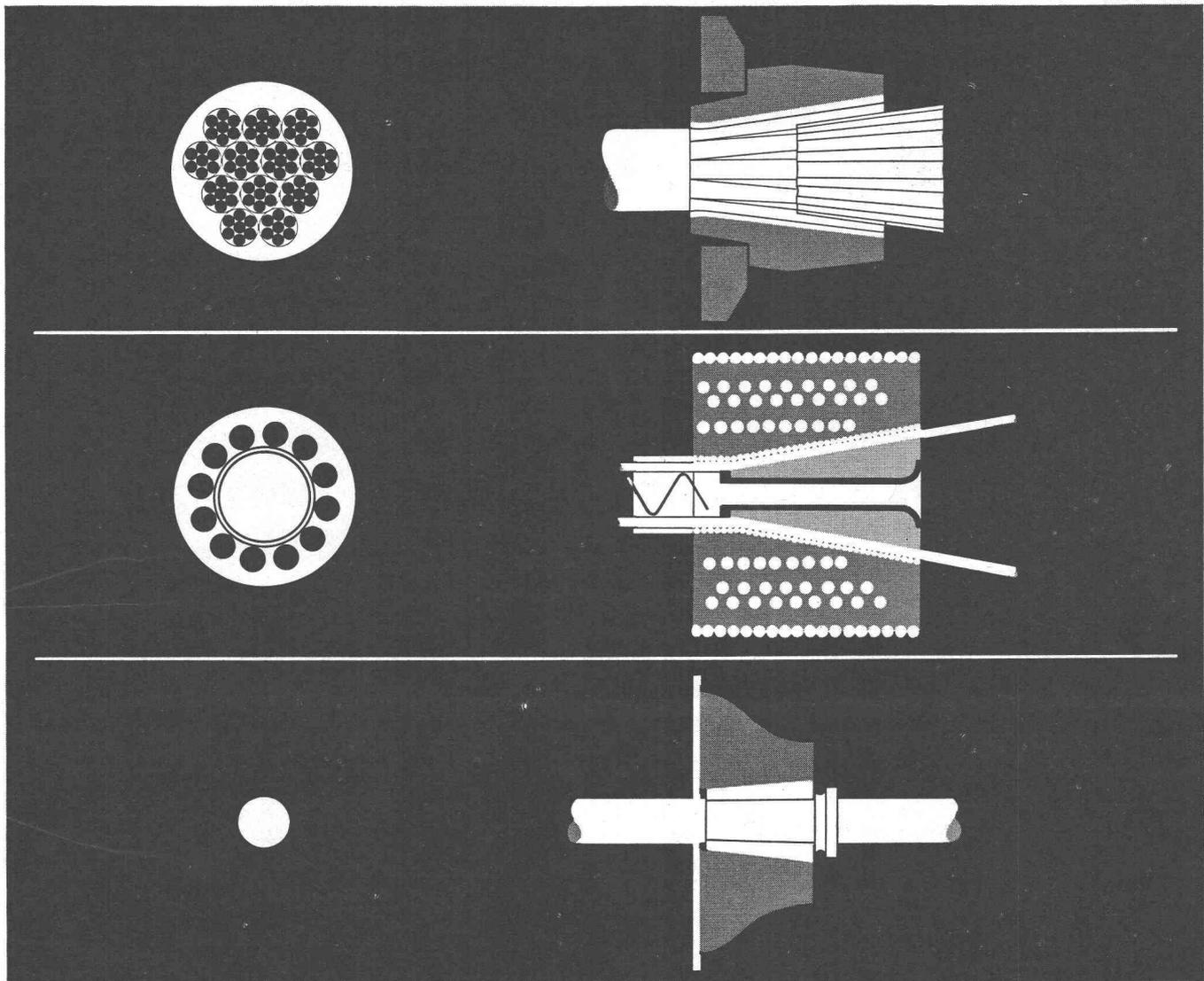
A 12 torons, à 12 fils ou monofil, toutes les unités Freyssinet de précontrainte présentent des propriétés identiques. Elles sont robustes, d'une manutention aisée et leurs ancrages d'une grande simplicité et d'une sécurité absolue.
