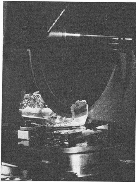
Fig. 21. Sciage d'un bloc à la scie diamantée.
