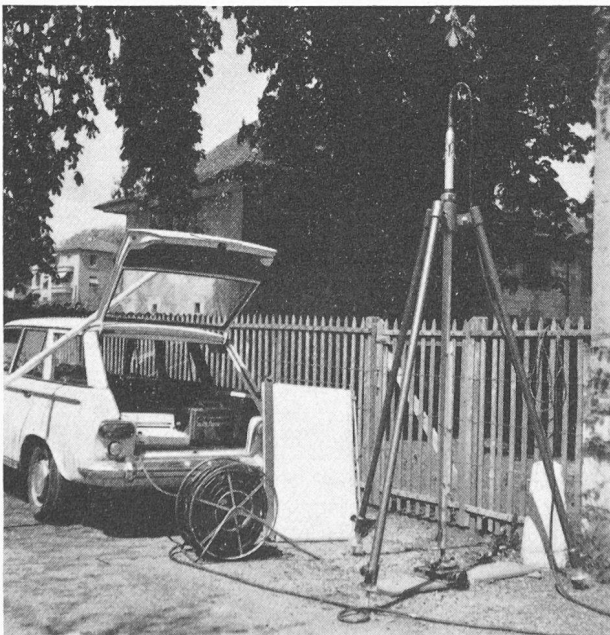
↑ Fig. 8. — Inclinomètre Télécline sur son trépied d'étalonnage. Appareil de précision capable de percevoir des variations de pente de l'ordre de 0,1 mm par m. Une boussole à télémessure permet de contrôler son orientation.
