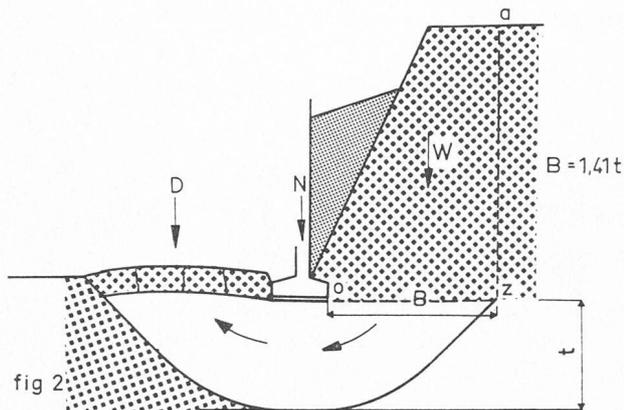
Fig. 2. — Mécanisme de la rupture (d'après Terzaghi).
