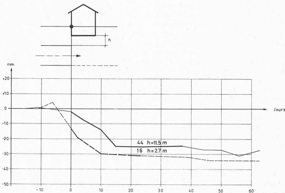
Fig. 13. — Tassements mesurés en fonction du temps, du terrain naturel au-dessus du voussoir ausculté.
