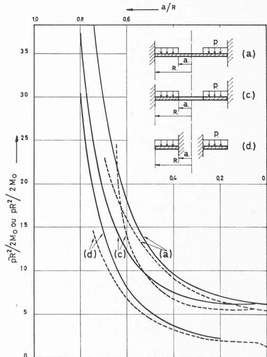
Fig. 8. — Charges limites non dimensionnelles pour les plaque encastées.
