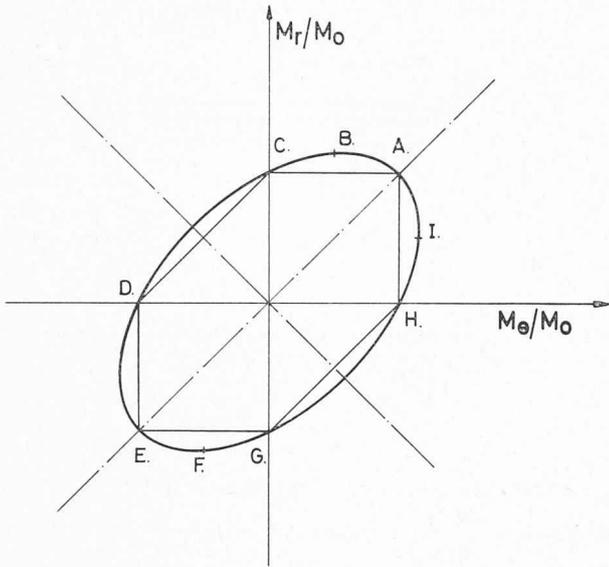
Fig. 2. — Condition de plasticité de Von Mises.
