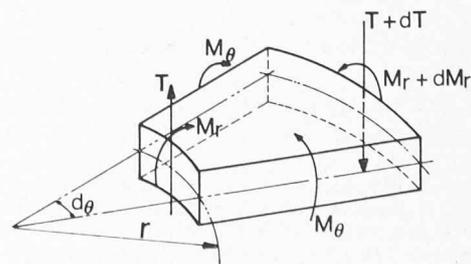
Fig. 1b. — Eléments de réduction sollicitant un élément de plaque.
