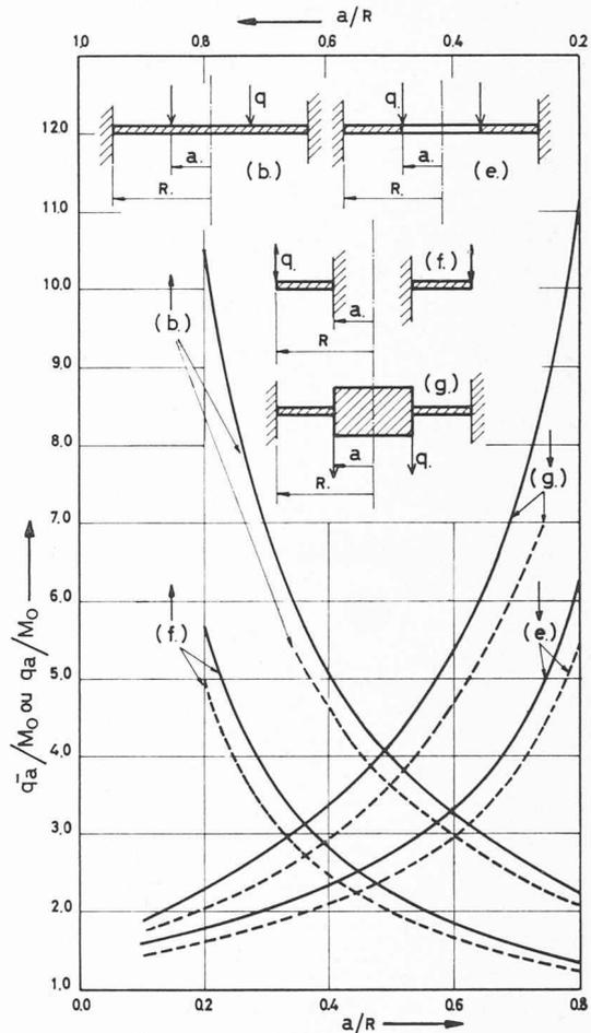
Fig. 7 — Charges limites non dimensionnelles pour les plaques encastées.
