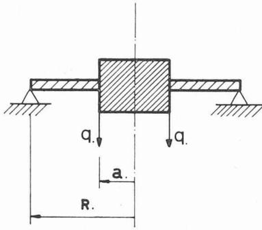
Fig. 6. — Plaque avec un renforcement central soumise à une ligne de charge sur le contour extérieur du renforcement.
