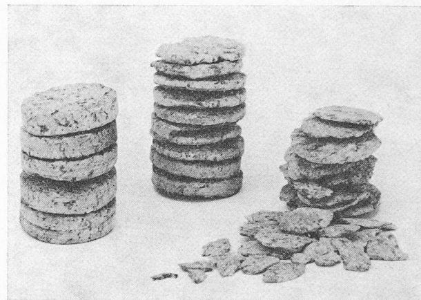
Fig. 9. — Discage des carottes de sondage. (document mis à disposition par M. Panet [33]).
