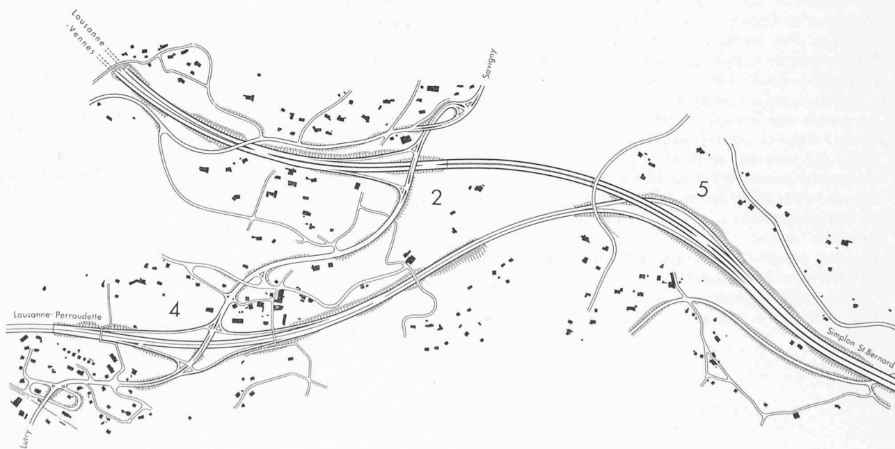
Fig. 3. — Complexe de Lutry comprenant la demi-jonction de Belmont (2), la jonction de Lutry (4) et l'échangeur de La Croix-sur-Lutry (5).
