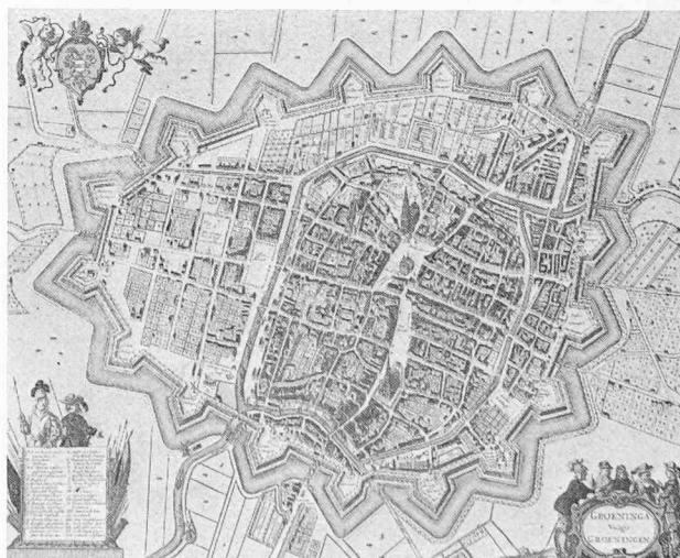
Fig. 4. — Détail du plan de J. Blaeu(?) de 1643. A droite, de bas en haut, le « Nieuwe » ou « Zuiderdiep » avec 2 passerelles en bois pour piétons et au milieu un pont voûté en briques pour la rue principale (Herestraat). A gauche de ce pont, le « Esserhuis » avec jardin à l'arrière le long du « Zuiderdiep ».
