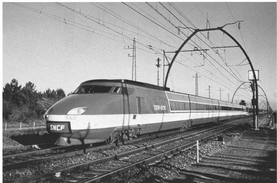
Fig. 28. — Turbo train SNCF TGV 001. A atteint en automne 1972 la vitesse de 318 km/h.
