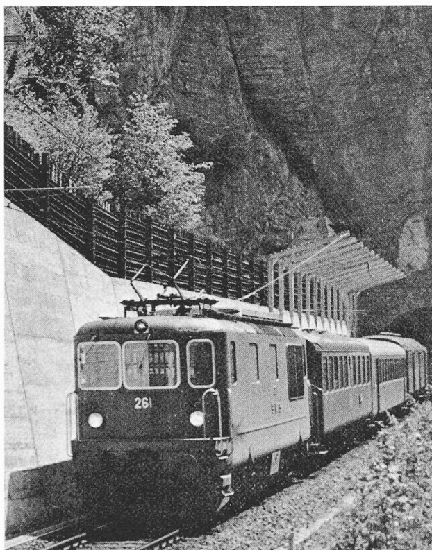
Fig. 13. — Locomotive Re 4/4 remorquant un convoi entre Blausee et Kandergrund. On aperçoit à l'arrière-plan à droite les filets de protection et d'alarme en cas de chutes de pierre, mis au point par le BLS et les Câbleries de Brougg. Lorsqu'une pierre rompt une maille du filet, constitué de conducteurs électriques, le courant est interrompu dans la ligne de contact (photo W. Ritschard/BLS).
