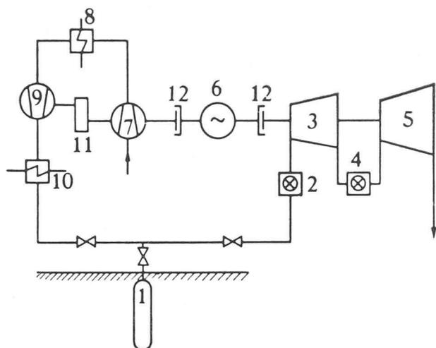
Fig. 1. — Schéma d'une centrale à réservoir d'air.
