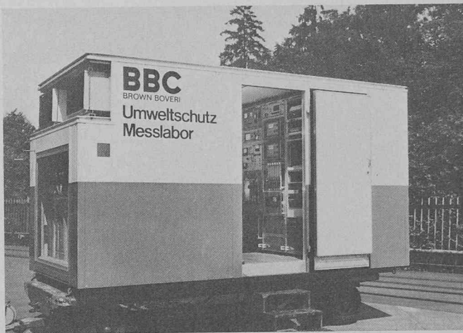
Fig. 1. — Laboratoire de mesure mobile pour la protection de l'environnement, destiné aux mesures d'émission et d'immission.
