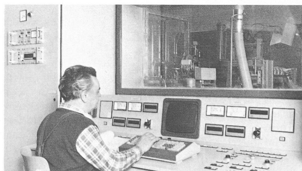
Poste de commande d'un banc d'essais automatique de moteurs.
