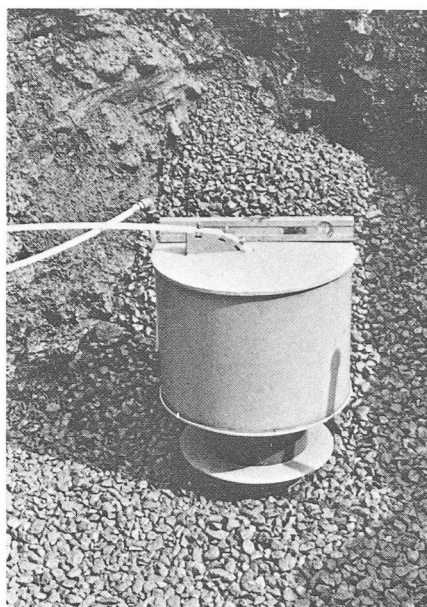
Fig. 7. — Tassomètre LEGEP. Cellule mobile solidaire de la fondation.
