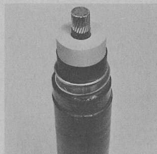
Câbles haute tension 150 kV à isolation EPR et gaine ondulée en aluminium, type GALW-T, 1x300 mm 2 .
