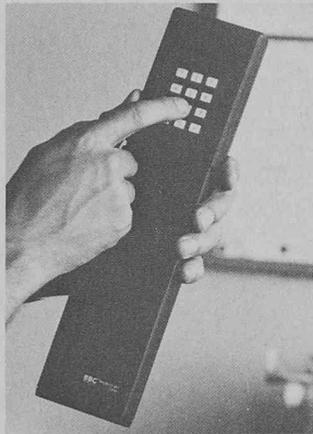
L'appareil de cryptage de conversations Brown Boveri Vericrypt 1100 garantit la préservation du secret des échanges d'informations. Il est spécialement conçu pour être utilisé dans les réseaux radio mettant en œuvre des radiotéléphones portatifs. La méthode de codage temporelle utilisée convient pour tous les systèmes radio connus (photo Brown Boveri).
