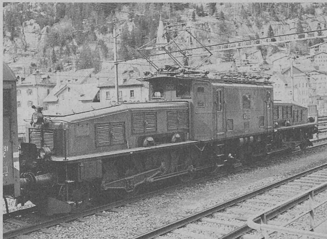
Hier: 128 t, 2240 ch, 65 km/h (Ce 6/8 II de 1920). Aujourd'hui: 120 t, 10 600 ch, 140 km/h (Re 6/6, en bas de page). (Photos: J.-P. Weibel)
