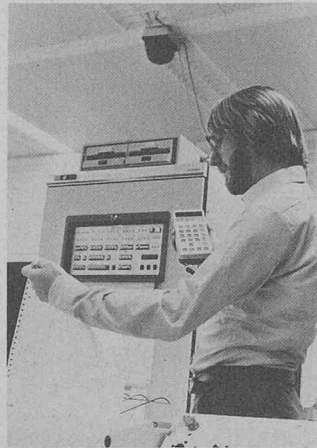
Système d'assurance qualité QGIS: terminal portatif à infrarouges avec clavier et affichage alphanumérique en cours de test en liaison avec la station relais fixe et le calculateur industriel R 30 des systèmes Siemens 300.
