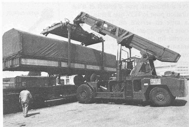
Fig. 9. — Chargement d'un semi-remorque sur un wagon à poche (« kangourou ») par une grue automobile de 35 t, à Milan-Rogoredo.
