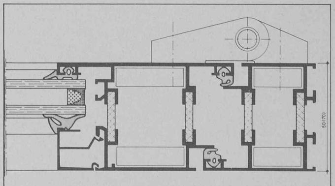
Fig. 1. — La nouvelle construction de porte *Alisol 2*.
