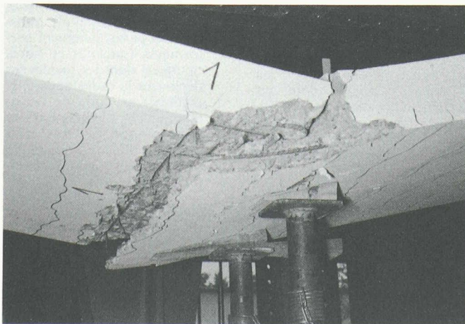
Fig. 9. — Rupture des dalles d'essai 1 et 5.
