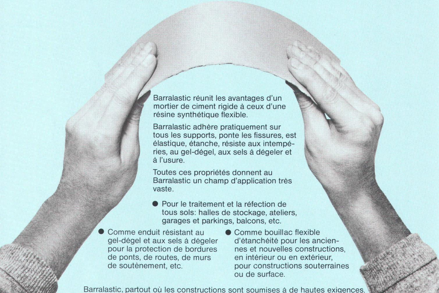
Barralastic réunit les avantages d'un mortier de ciment rigide à ceux d'une résine synthétique flexible.
