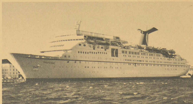
« Tropicale » (30 000 tjb) des Carnival Cruise Lines, équipé de 2 moteurs diesel Sulzer à marche lente, développant une puissance totale de 19 560 kW (26 600 ch).
